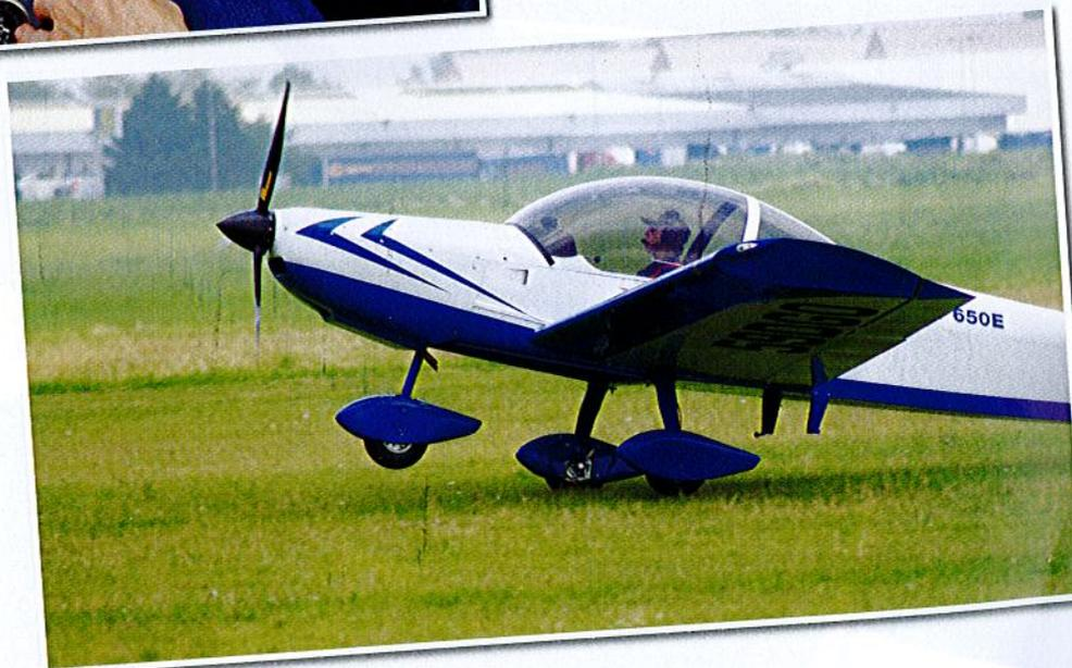
Sur l'ULM, le montage d'une lame en remplacement des demi-trains des avions Zenair permet de simplifier le fuselage.
